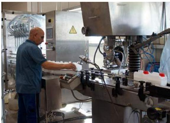
Die Kanister werden befüllt, verschraubt und etikettiert.
