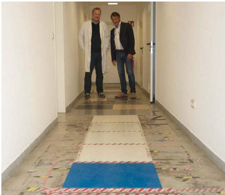
Dr. Olaf Janßen und Frank Knott hinter der Belags-Teststrecke: Unter realen Bedingungen werden die Versiegelungen auf den verschiedenen Bodenbelägen getestet.
